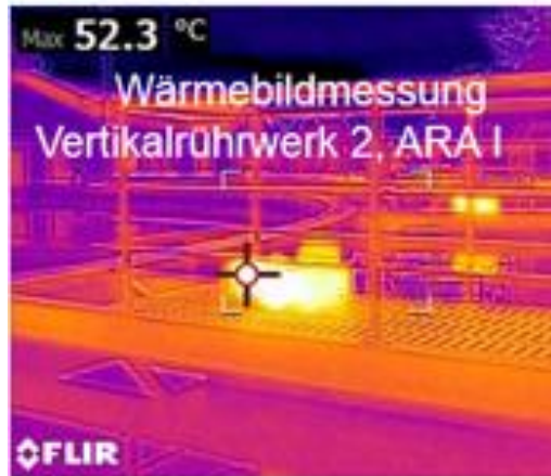
Bild: Kombination von Wärmebild- und Vibrationsmessungen zur Detektion von Rührwerksproblemen auf einer Kläranlage (Bildquelle: Wiese)
