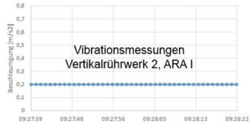
Bild: Kombination von Wärmebild- und Vibrationsmessungen zur Detektion von Rührwerksproblemen auf einer Kläranlage (Bildquelle: Wiese)
